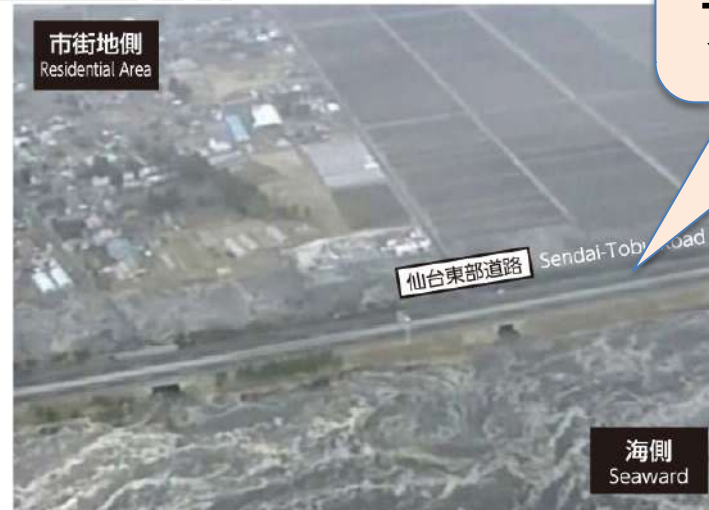
仙台東部道路が内陸の市街地への津波・がれきの流入を抑制
